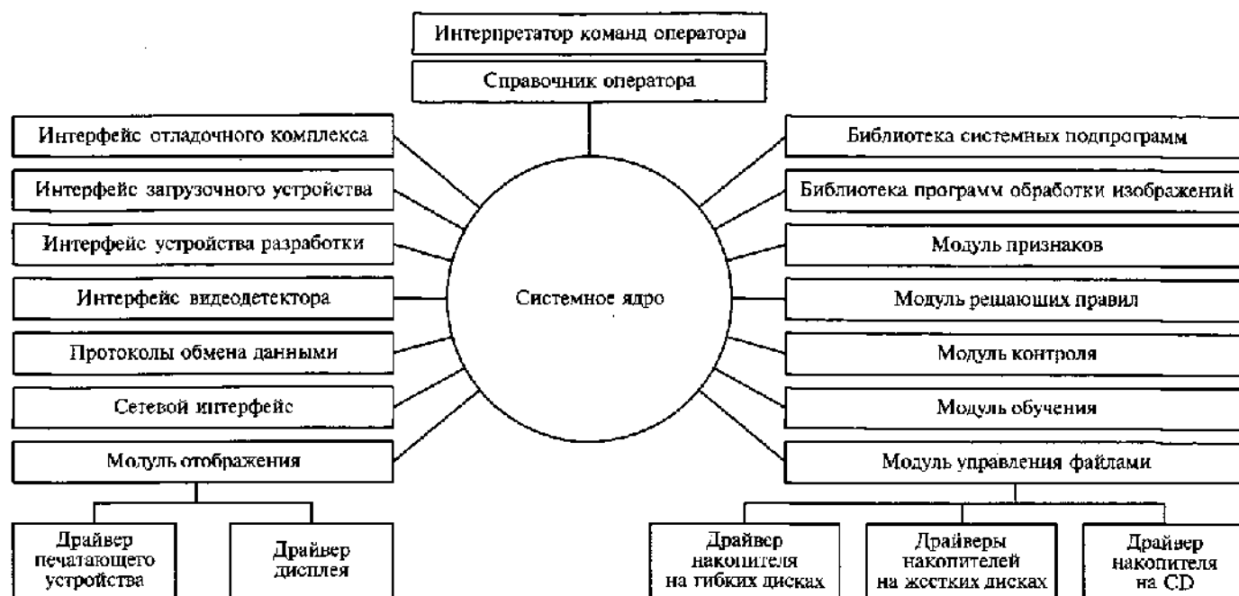
Рис. 8.17. Структура программного обеспечения ИИС
