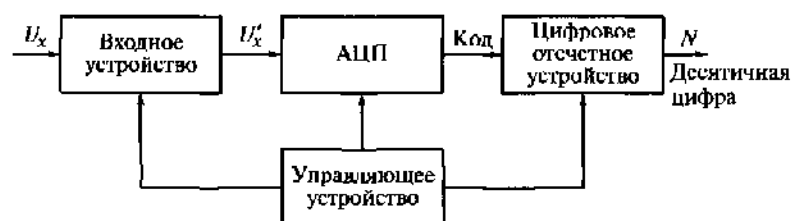
Рис. 14.15. Упрощенная структурная схема цифрового вольтметра
