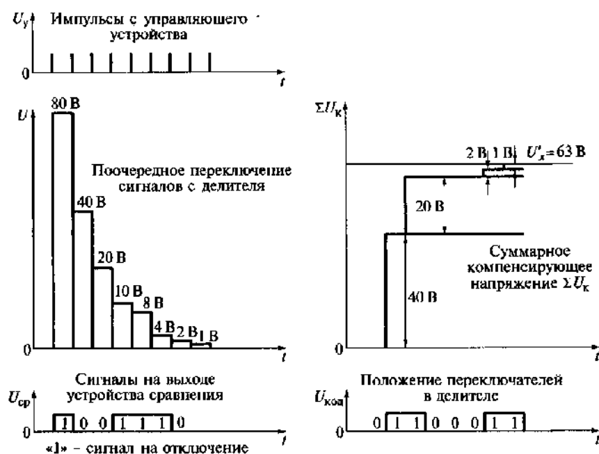
Рис. 14.18. Графики, показывающие работу кодово-импульсного вольтметра
